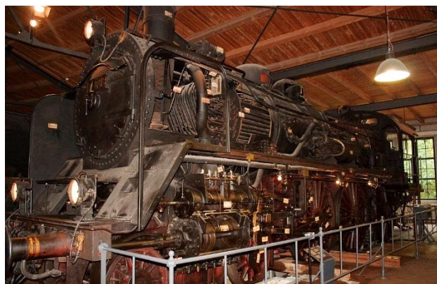
Aufgeschnittenes Funktionsmodell der Baureihe 17
